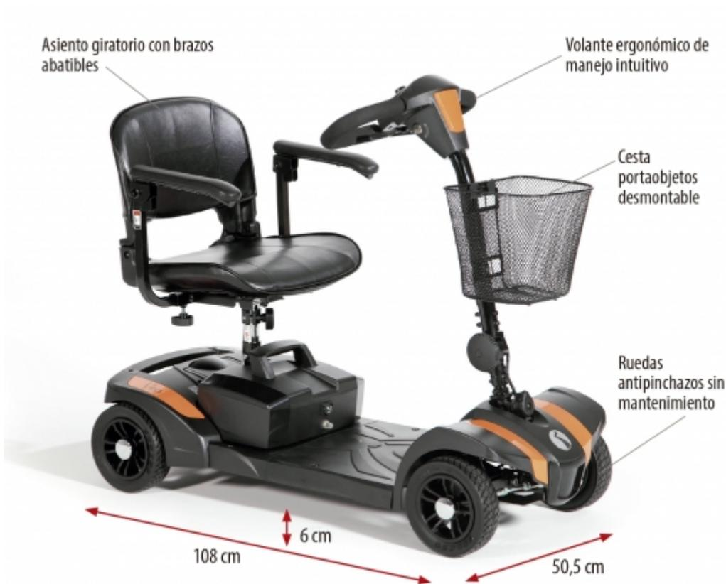
El scooter VEO de diseño moderno y atractivo, es ligero y desmontable en 3 partes, siendo la más pesada de tan solo 17 kg. De construcción robusta y muy maniobrable, con autonomía aproximada de 19 km. Ofrece un mayor espacio para las piernas del usuario que otros scooters de su misma clase. Esto hace que sea muy versátil para usuarios
