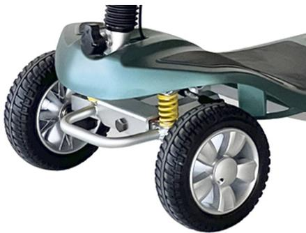
Equipado con **suspensión en las 4 ruedas** para que la conducción sea una experiencia agradable y de confort.
