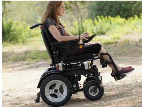
La silla R750 tiene un diseño moderno y robusto gracias a la forma del chasis tubular fabricado en aluminio.
