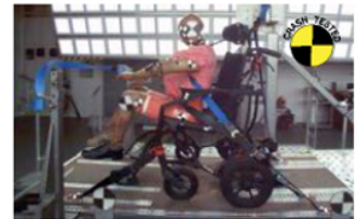
891 Anclaje (4 anillos) para el transporte, en dirección del sentido de marcha, en vehículos homologados en movimiento (coche, bus, etc.) Consulte el manual de uso y mantenimiento suministrado con la ayuda.
