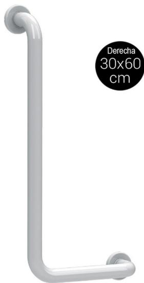
Barras muy resistentes especialmente recomendadas para la ducha. Fabricadas en acero con recubrimiento epoxi color blanco. Están disponibles en mano derecha e izquierda. Diámetro 32 mm. Con embellecedores que ocultan los tornillos que las aseguran a la pared.
