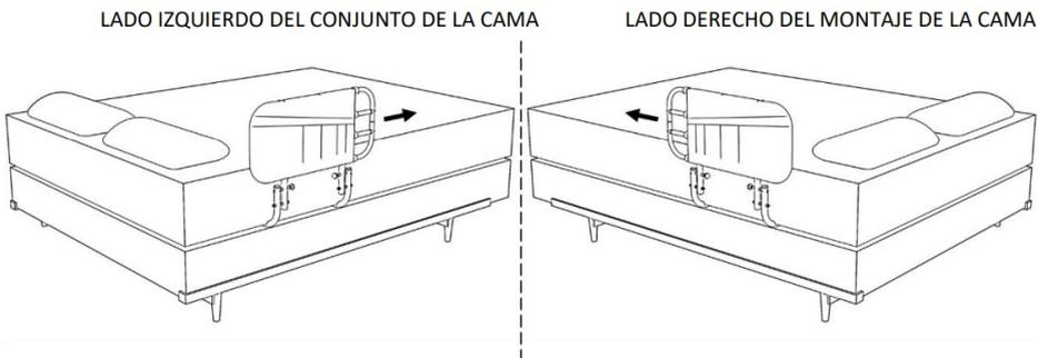
2- Coloque el arco de la base (A) en los tubos laterales (B). Presione los pivotes para insertar a los tubos.
