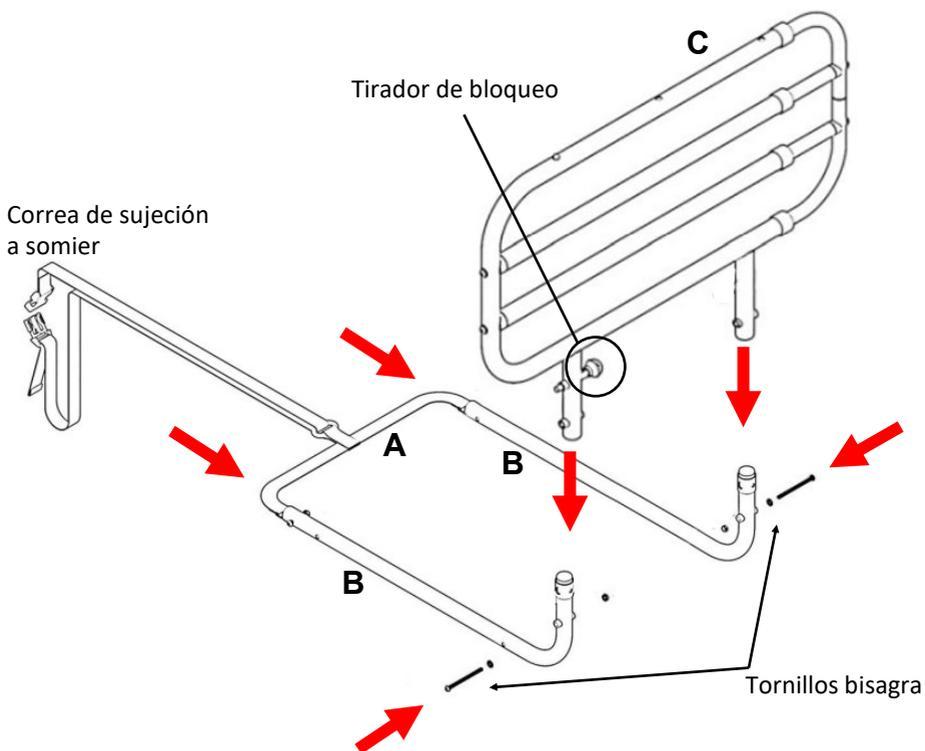
1- Determine en qué lado de la cama debe instalarse el producto, como se muestra en la FIGURA. El lado ajustable en longitud de la barandilla de la cama debe estar siempre orientado hacia el extremo de los pies de la cama.
